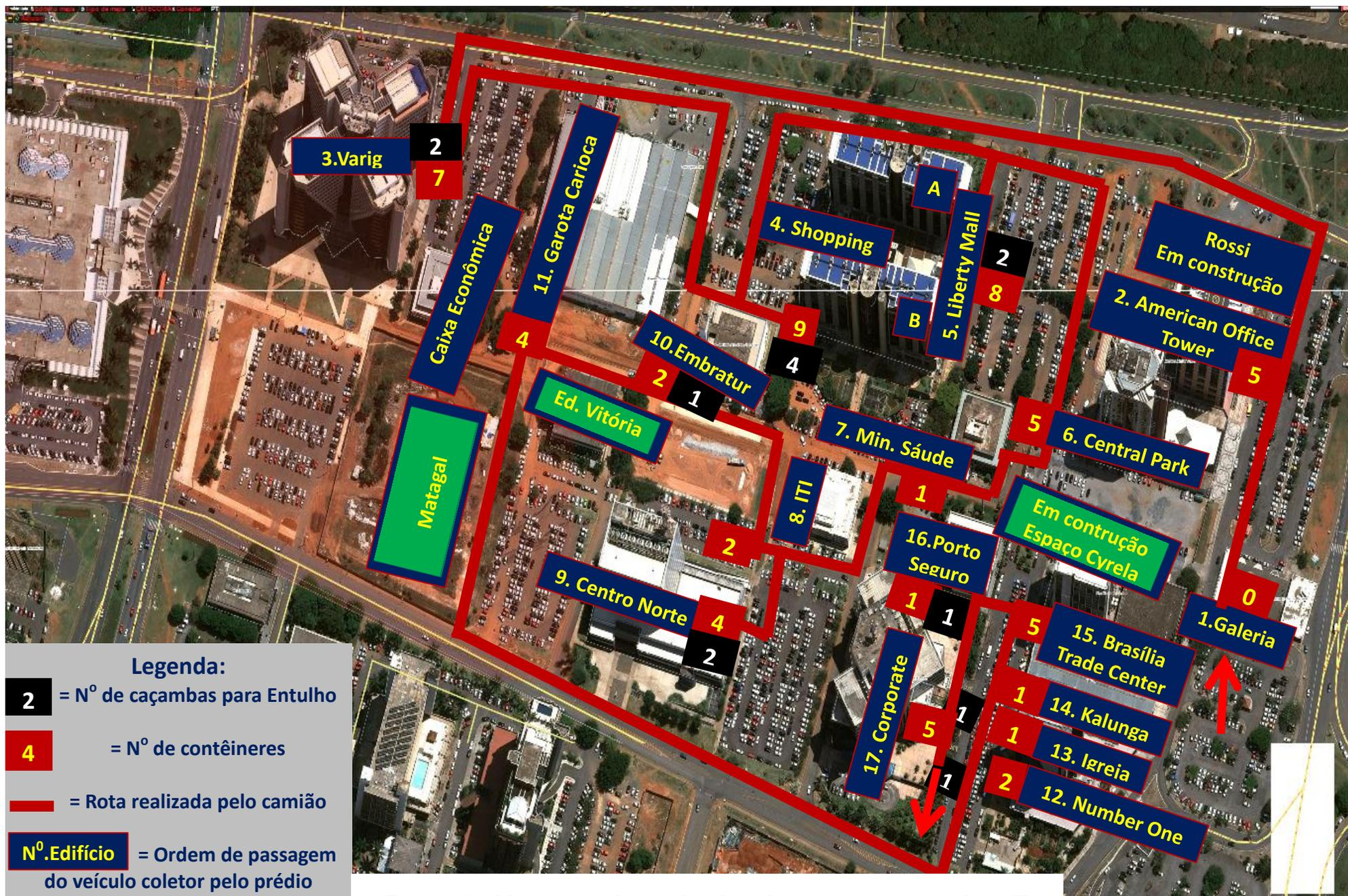
Figura 5.24: Mapeamento da rota de coleta, dos contêineres e caçambas – II
