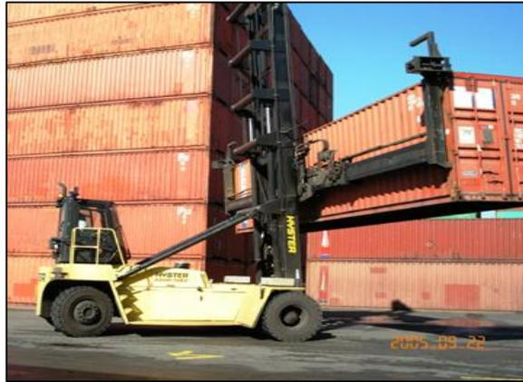
Figura 3.4 - Empilhadeira com capacidade superior a 30 ton.
